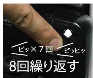
③ 指紋認証を8回繰り返す。 認証の度にビップという音になる。 8回目はビップビップと2回音になる。
