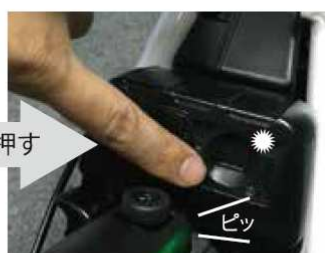
② 再度SETボタンを押す。 (ビップ 白LEDが点滅)
